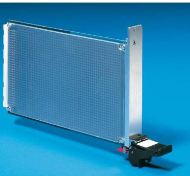
Для механической защиты стороны с компонентами, а также контактных пружин. Крепежные отверстия в соответствии со спецификацией CPCl или VME. По выбору: исполнение с перфорацией или глухое.
