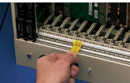
Для простого монтажа кодовых штырьков. Можно установить до 3 кодировочных штырьков. Позиционирование облегчает встроенный центрирующий штифт.
