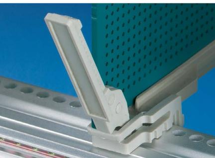
Выталкиватель карт из двух частей предназначен для фиксации и выталкивания печатных плат без передних панелей. Нижнюю часть можно использовать отдельно только для фиксации карт.
