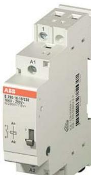
Электромеханические блокировочные реле E290 замыкают и размыкают свои контакты при каждом импульсе, посланном на катушку управления посредством кнопки с НО контактом. Эти реле используются для управления освещением, как из одной, так и из нескольких точек. Имеются различные исполнения в зависимости от питающего напряжения и количества контактов. Реле E290 могут объединяться с модулями силовых и вспомогательных контактов, а также модулями управления.
