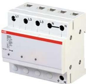
Устройства защиты от импульсных перенапряжений OVR T1+2 созданы на базе разрядника и варистора. Защищают от перенапряжений, вызванных прямым ударом молнии (фронт волны 10/350мкс), удаленным ударом молнии, а также от перенапряжений в сети технологического характера (фронт волны 8/20мкс).
