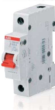
Выключатели нагрузки SHD200 серии Compact Home повторяют профиль автоматических выключателей SH200L, соединяются стандартными шинными разводками. В гражданском строительстве часто используются для коммутации разветвленных и уже защищенных цепей для исключения возможности отключения нескольких нагрузок при коротком замыкании. Номинальный ток от 16 А до 63 А.
