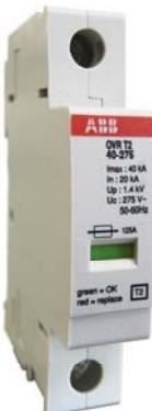
Устройства защиты от импульсных перенапряжений OVR T2 созданы на базе варистора и защищают от перенапряжений, вызванных удаленным ударом молнии, а также перенапряжений в сети технологического характера (фронт волны 8/20мкс).
