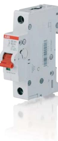
Выключатели нагрузки SD 200 серии System pro M compact повторяют профиль автоматических выключателей S200. Среди преимуществ серии SD200 надо отметить двойные цилиндрические клеммы, наличие индикатора состояния контактов и полную совместимость с аксессуарами для автоматических выключателей S200. Номинальный ток от 16 А до 63 А.
